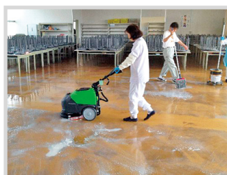
▲ワックス床の洗浄や剥離作業に
