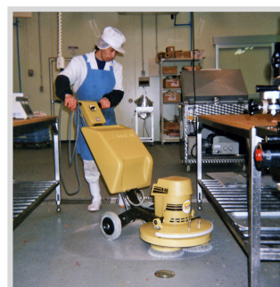
▲食肉加工工場床の脱脂洗浄
