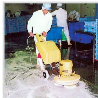
▲水産加工工場床の脱脂、黒カビの洗浄
